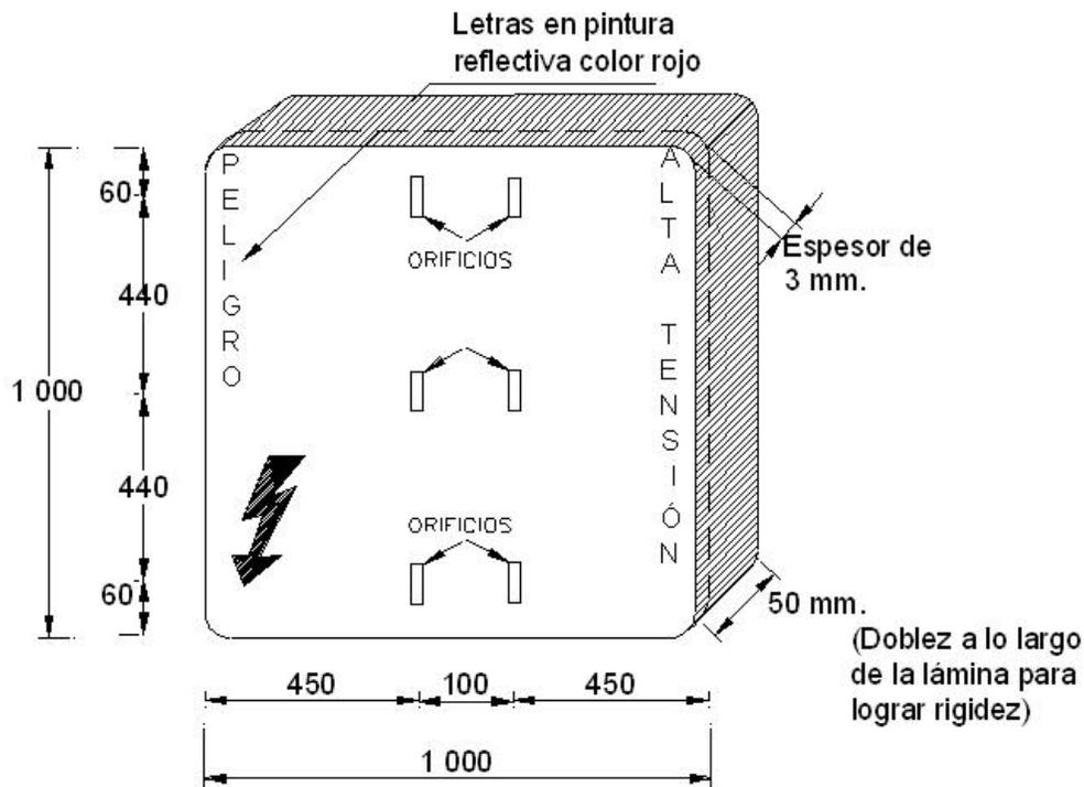
Material: Policarbonato transparente con capa protectora de radiación UV
