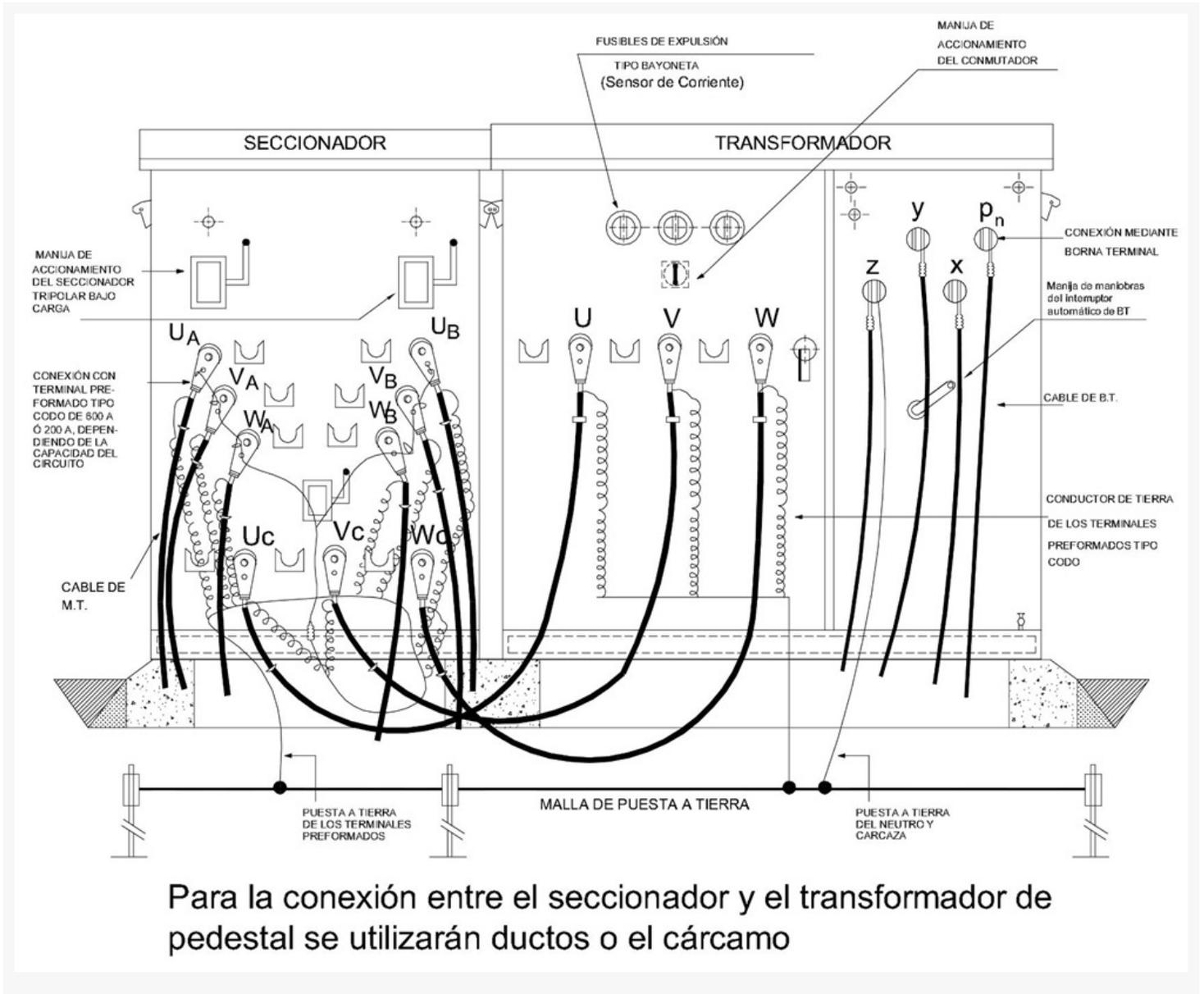
Para la conexión entre el seccionador y el transformador de pedestal se utilizarán ductos o el cárcamo
