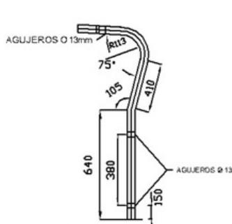
TUBO GALVANIZADO EN CALIENTE Ø 1 1/2"
