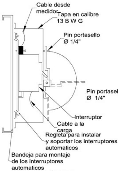
**BLOQUEADOR MECANICO PARA CORTE DE ENERGIA**
