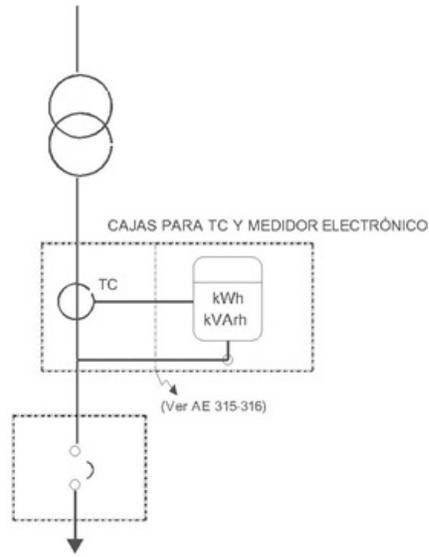
FIG 1 -CAJAS PARA MEDICIÓN SEMIDIRECTA
