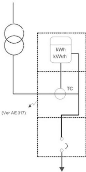
FIG 2 -ARMARIO PARA MEDICIÓN SEMIDIRECTA.
