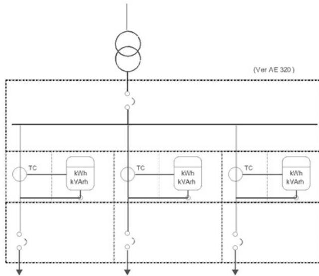
FIG 3-ARMARIO PARA MEDICIÓN SEMIDIRECTA.
