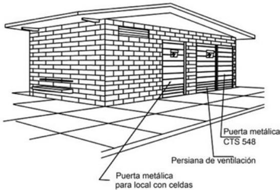
La puerta debe colocarse en uno de los muros de mayor longitud y en un extremo, abriendo hacia el exterior.
