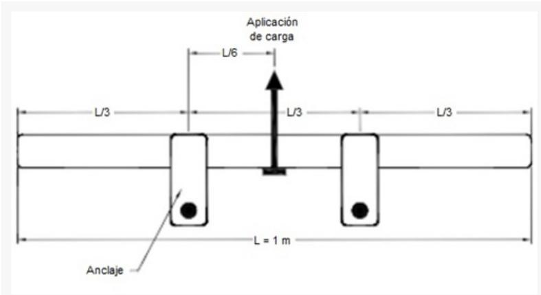
Figura 2. Esquema para la prueba de perno pasante
