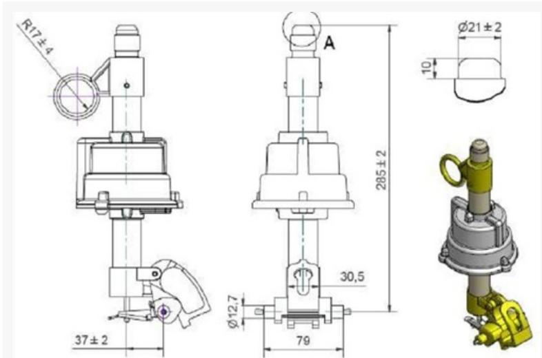
Figura 2. Dimensiones referenciales equipo 15 kV, en mm.
