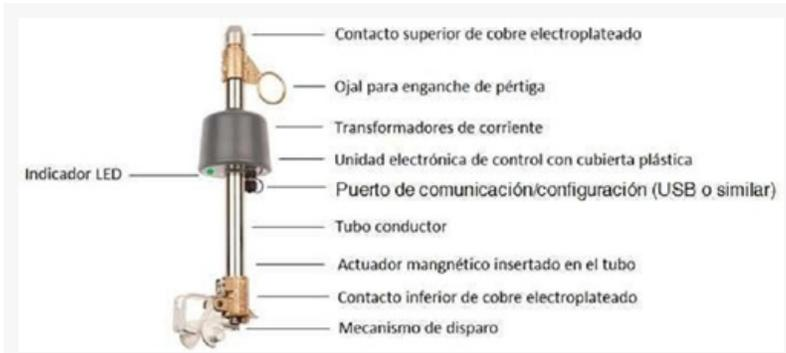
Figura 1. Componentes del equipo.
