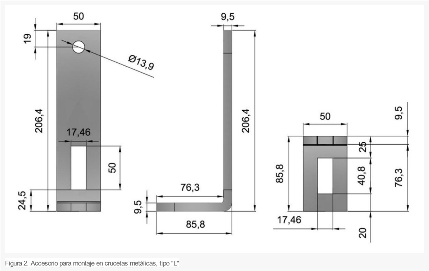
Figura 2. Accesorio para montaje en crucetas metálicas, tipo "L"
