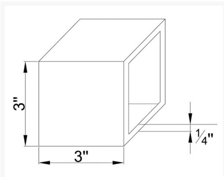
Figura 1. Accesorio para montaje en crucetas metálicas, tipo "Dado"
