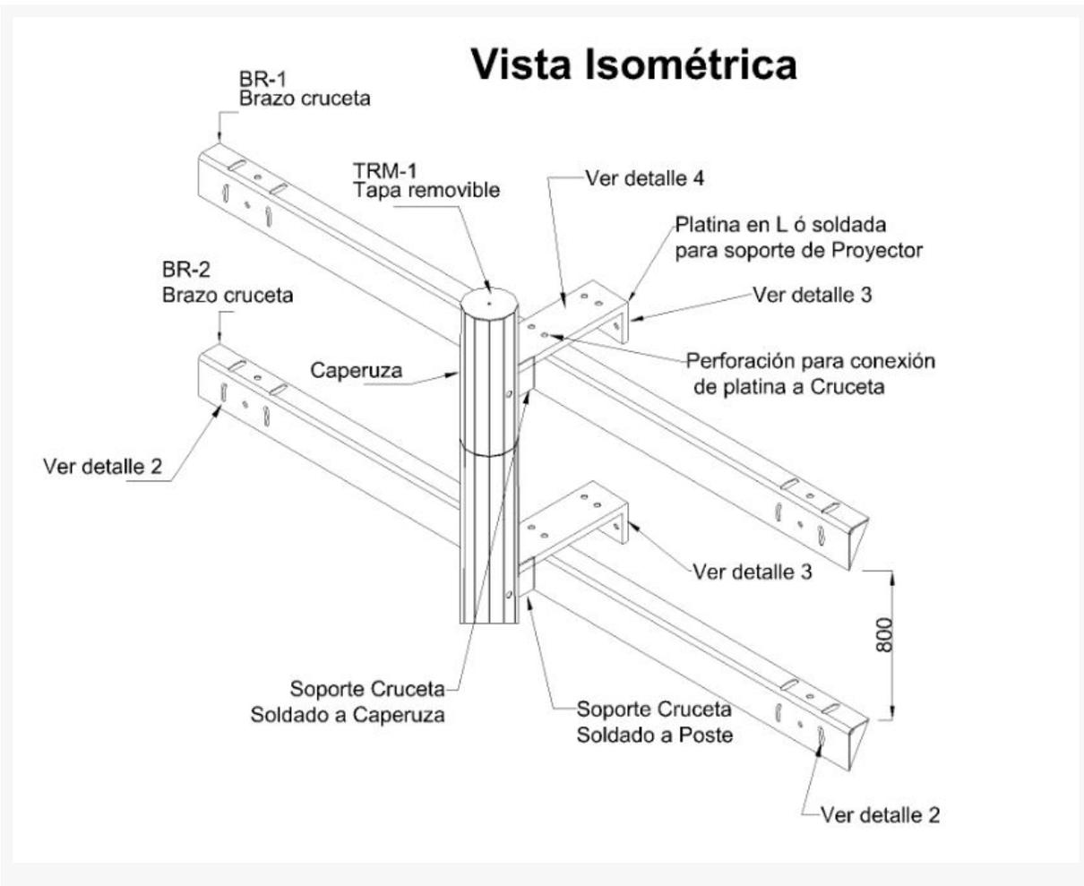
FIGURA 4A. Detalles y cortes de caperuza y soporte a poste
