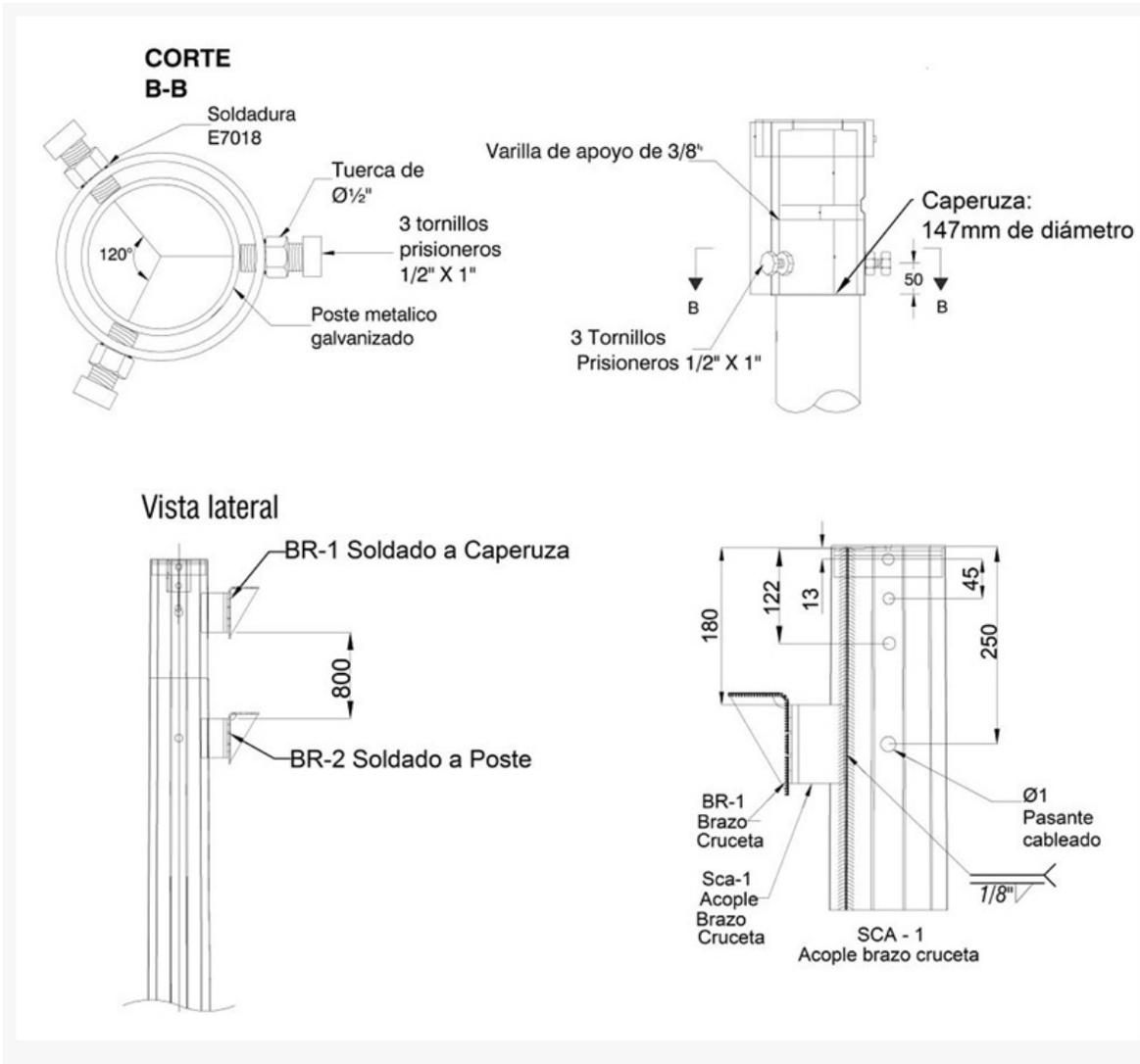
FIGURA 4B. Detalle dimensiones cruceta para instalación de proyectores
