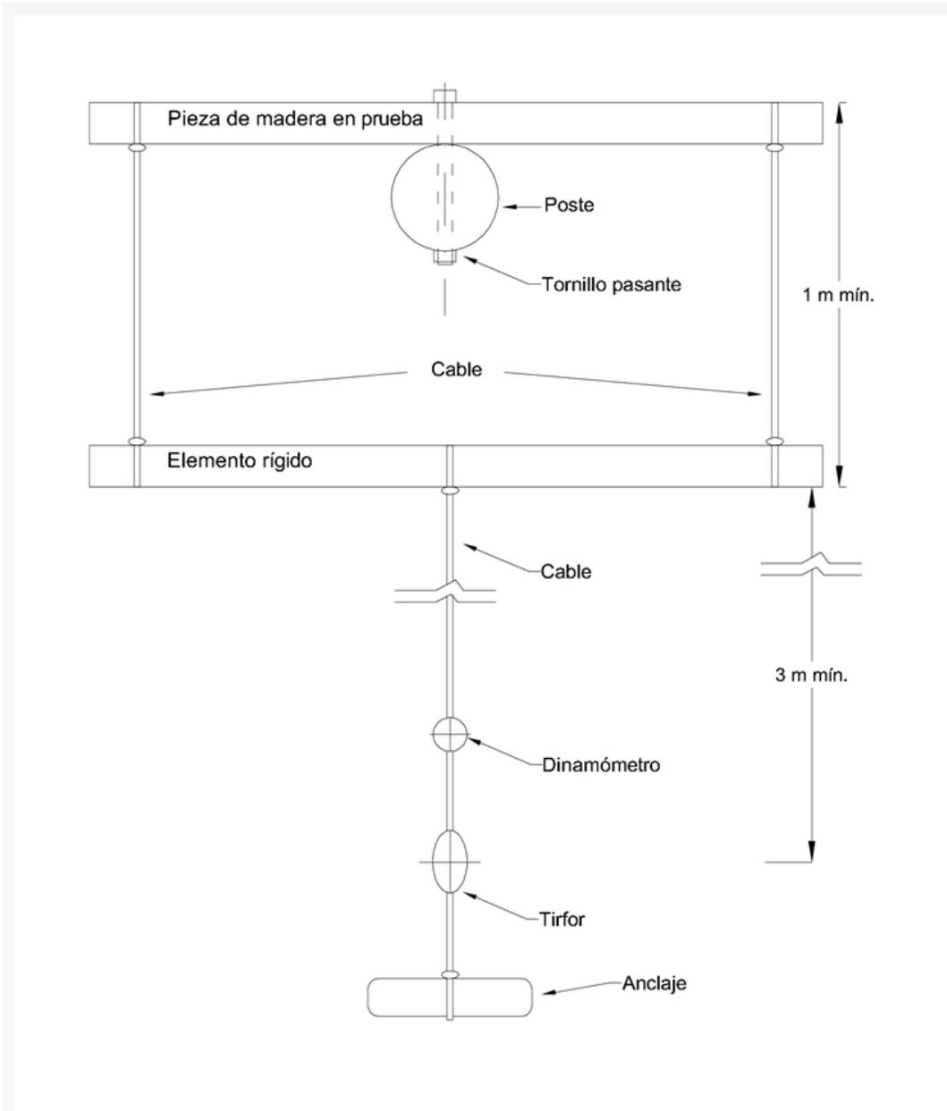
FIGURA 1 Ensayo de resistencia mecánica vista en planta
