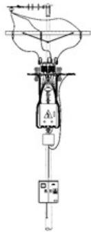
TRAFO EN POSTE FINAL DE CIRCUITO PRIMARIO CTU 500-1
