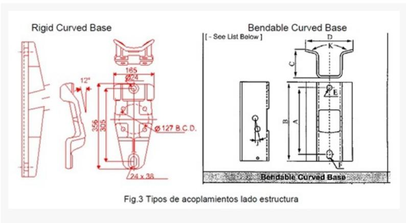
Fig.3 Tipos de acoplamientos lado estructura
