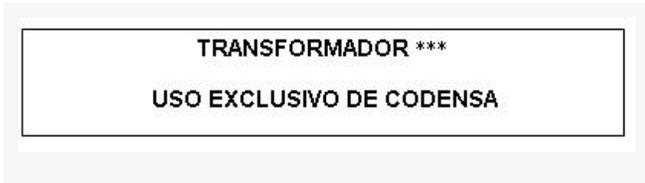
El tamaño de las letras será mínimo de 10 mm de altura. Los asteriscos se cambiarán por el nivel de la [tensión](#) de la red (11.4kV, 13.2kV o 34.5kV).
